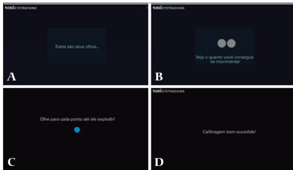
Figura 5 – Etapas de calibração do rastreador ocular.
